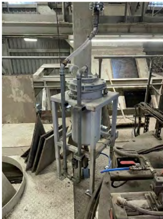
Figuur 9. Buffervat gemengd materiaal (links) en besturing hoeveelheid additief en water (rechts)
