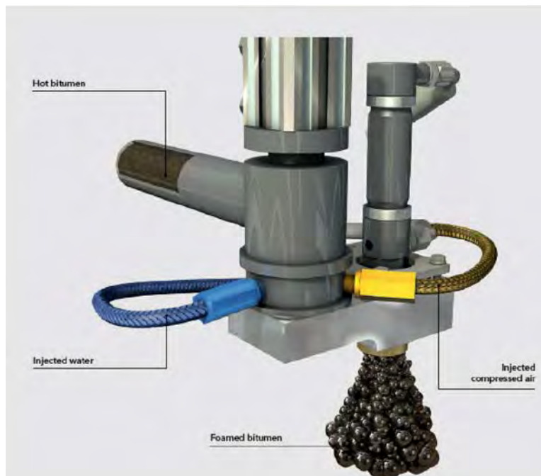
Figuur 5. Schuimbitumen uit laboratorium schuimunit
