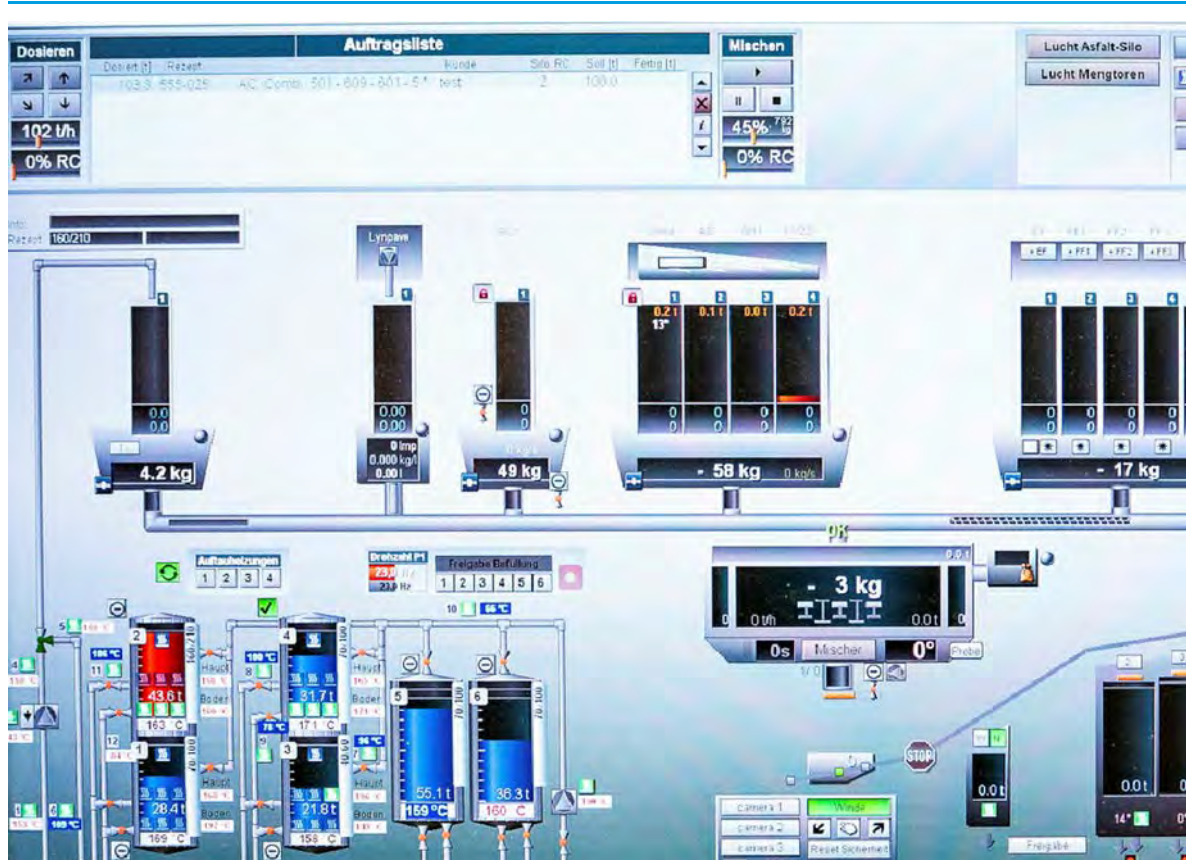
Figuur 5. Illustratie van besturingssysteem bij asfaltmenginstallatie
