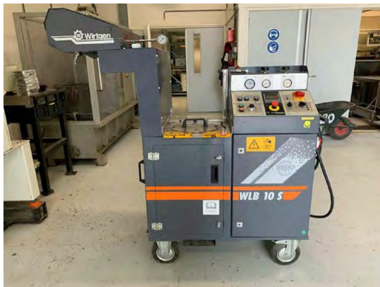
Figuur 4. Wirtgen WLB 10S laboratorium schuimunit
