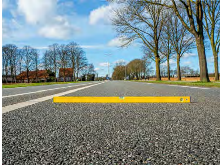
Figuur 9. Controle dwarsvlakheid SMA-NL 11B LynPave na 6,5 jaar
