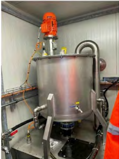
Figuur 9. Buffervat gemengd materiaal (links) en besturing hoeveelheid additief en water (rechts)
