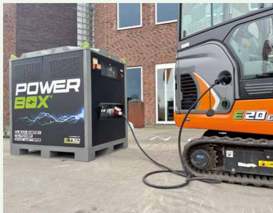
Opladen van emissieloos materieel.
