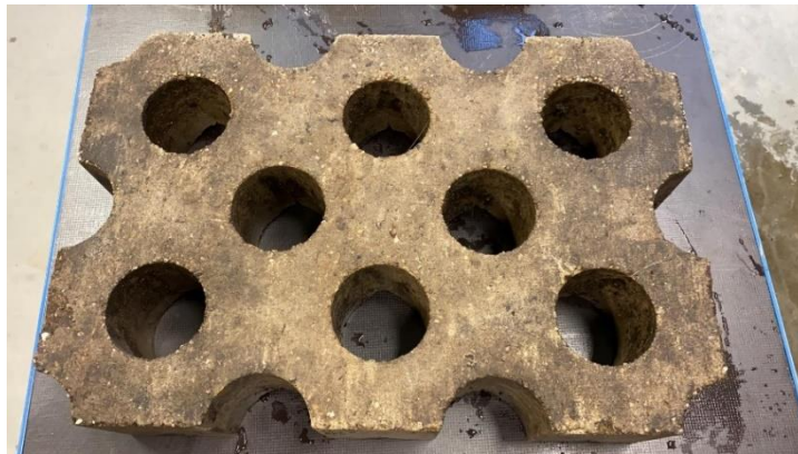
Figuur 32. Pilot Provincie Groningen: toegepaste geopolymer grasbetontegel.
