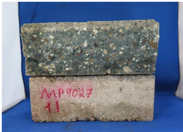
Figuur 6. Pilot Gemeente Alphen aan den Rijn: gespleten geopolymeer betonstraatsteen; de onderste helft laat de reguliere buitenkant van de steen zien, de bovenste helft het splijtvlak met daarop zichtbaar het geopolymeer onderbeton en de cement gebonden toplaag.
