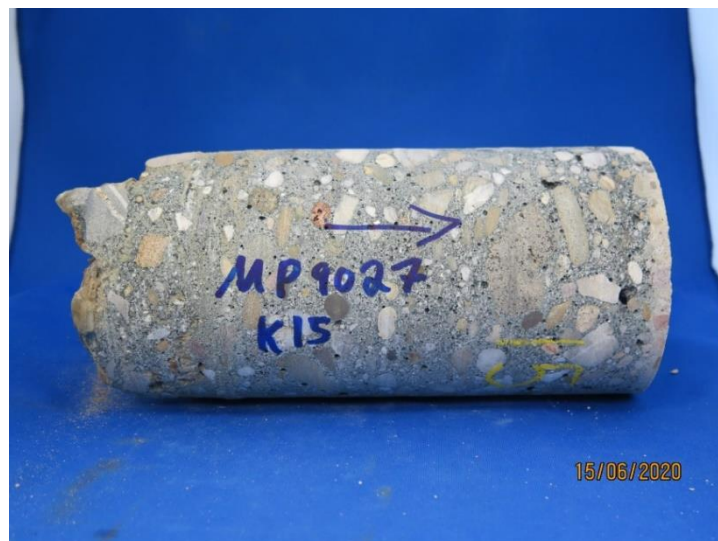
Figuur 34. Project Provincie Overijssel: boorkern uit in het werk gestort geopolymer beton.
