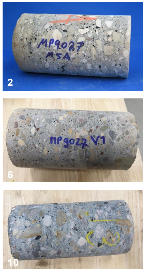
Figuur 38. Proeftuin Geopolymeren: kernen van in het werk gestort geopolymeer beton, geboord na een jaar. De nummers corresponderen met het pilotnummer, 2 – Provincie Gelderland. 6 – Gemeente Leeuwarden. 10 – Provincie Overijssel.
