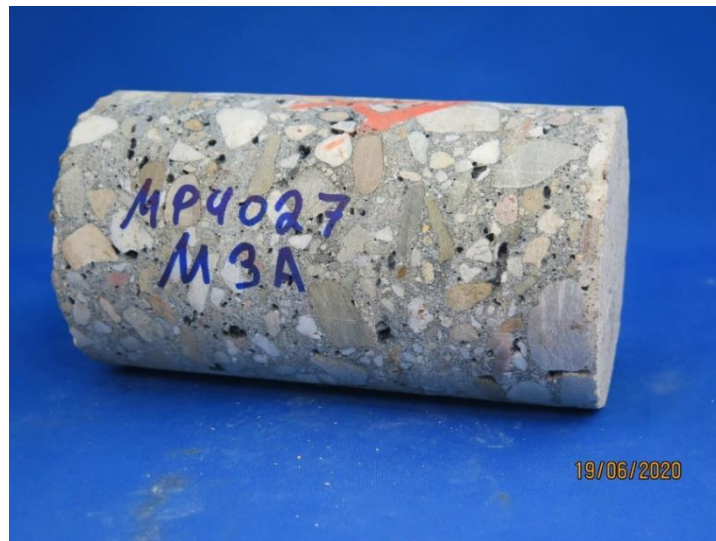
Figuur 9. Pilot Provincie Gelderland: boorkern uit het geopolymeer beton.
