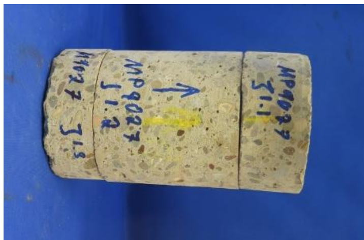
Figuur 23. Pilot Gemeente Leeuwarden: boorkern uit in het werk gestort geopolymeer beton.
