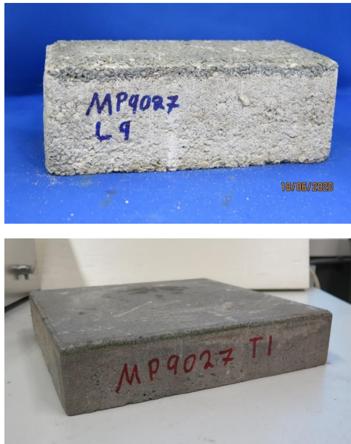
Figuur 15. Pilot Gemeente Amersfoort: geopolymer betonstraatsteen en tegel met cement gebonden toplaag.
