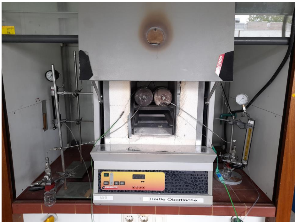
Figuur 2: overzicht moffeloven en opstelling
