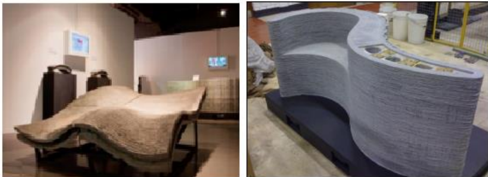
Afbeelding 1: concrete printing door Universiteit van Loughborough (2012)..
