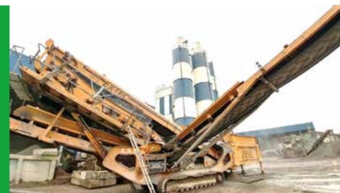
Scheidingsinstallatie fijne fractie
