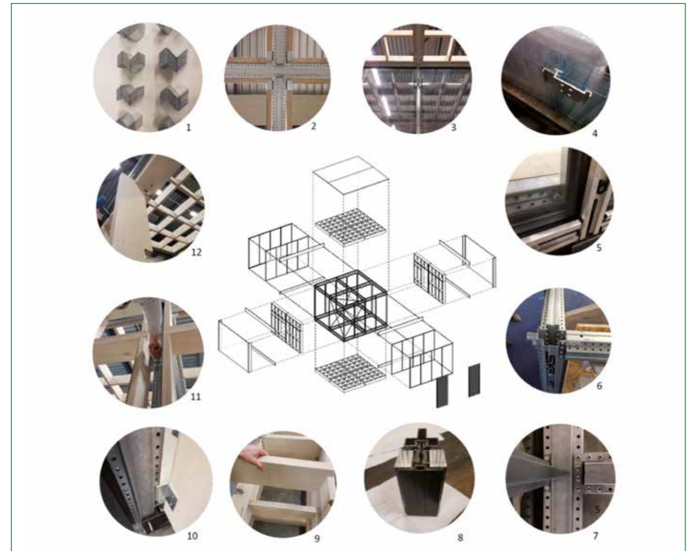
Overzicht van reversible principes en verbindingen zoals toegepast in GTB Lab Module.
