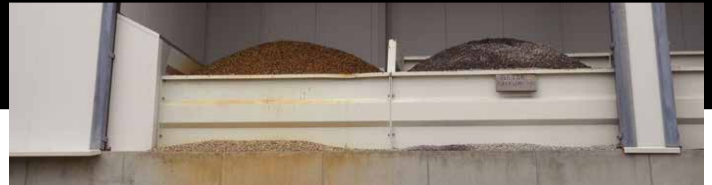
Maagdelijk grind (links) en betongranulaat liggen naast elkaar in bunkers, om afgewogen te worden in een betonmengsel.
