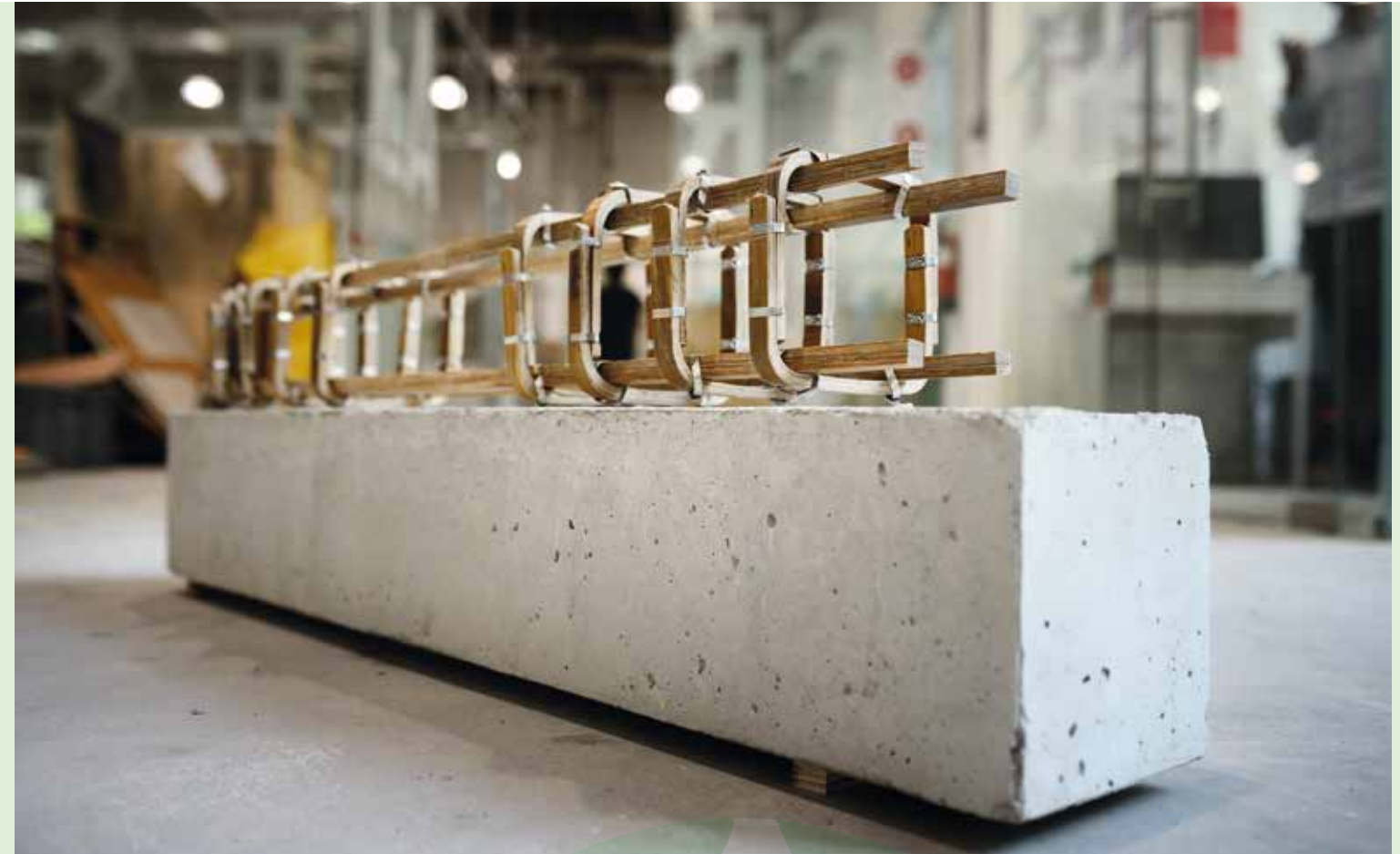
Bambootech, een met 10 procent organische hars versterkt bamboe dat Dirk Hebel ontwikkelde.
