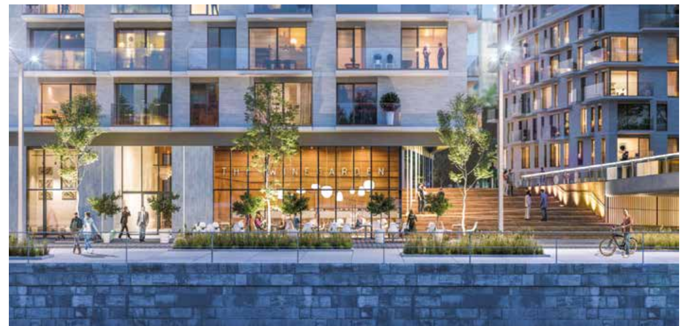
Kenmerkend voor Riva Brussels zijn de slanke balkons en vloerranden die vervaardigd zijn uit architectonisch beton en slechts 3 cm dik zijn.
