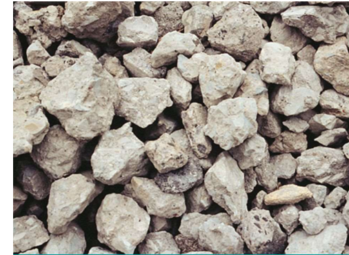
Fig: beton granulaat
