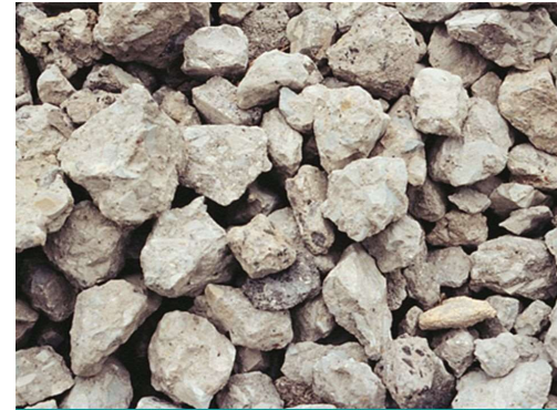
Fig: beton granulaat
